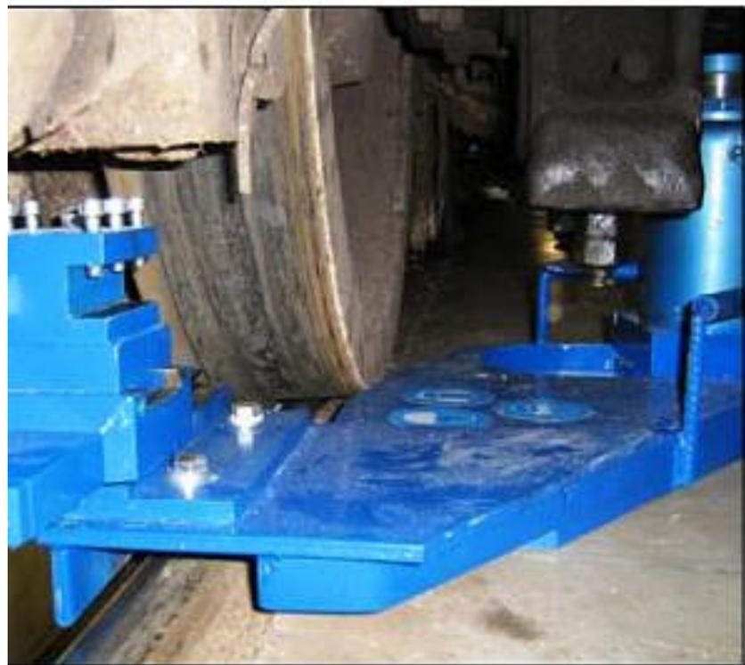
Держатель резца подводится к обрабатываемой поверхности колеса и начинается процесс обточки. Обрабатываемая поверхность контролируется профильным локомотивным шаблоном.
