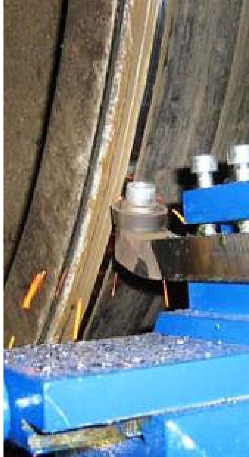
Фирма 1AK200 Ltd. г.Нарва, Эстония производит мобильное устройство 1AK200 ZIP предназначенное для обточки колес маневровых локомотивов типа ТЭМ2.
